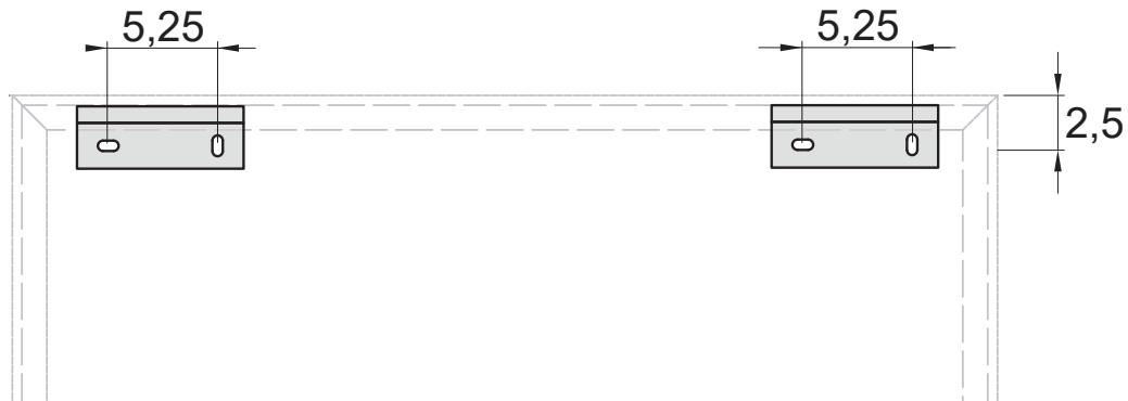
**N.B.** Dettaglio della squadretta di fissaggio
